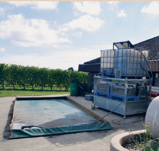
Mobiler Reinigungsplatz mit Osmofilm-Anlage am Strickhof, M. Hochstrasser
