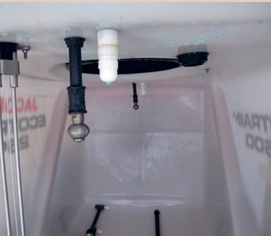
Spritzentank mit Innenreinigungsdüse, agrotop
