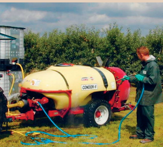
Reinigung einer Gebläsespritze auf einer bewachsenen Fläche, TOPPS
